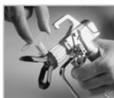
Positionner la buse dans le support en s'assurant que la flèche pointe vers l'avant (sens de pulvérisation).
