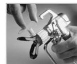
Positionner le support et la buse. Nettoyer vos buses en pulvérisant l'eau à haute pression et en retournant.
